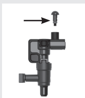
Спінуювач зі знімним патрубком всмоктування повітря
